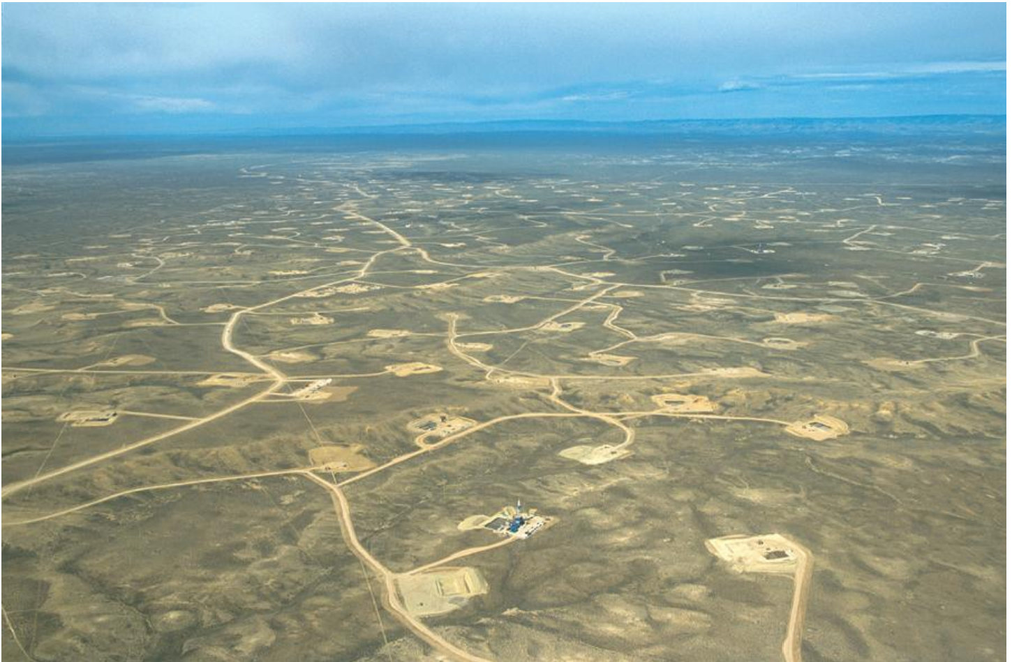
Plateformes de puits du champ de gaz du Wyoming – Impact potentiel en surface des puits forés verticalement, champ gazier de Jonah, Wyoming.
